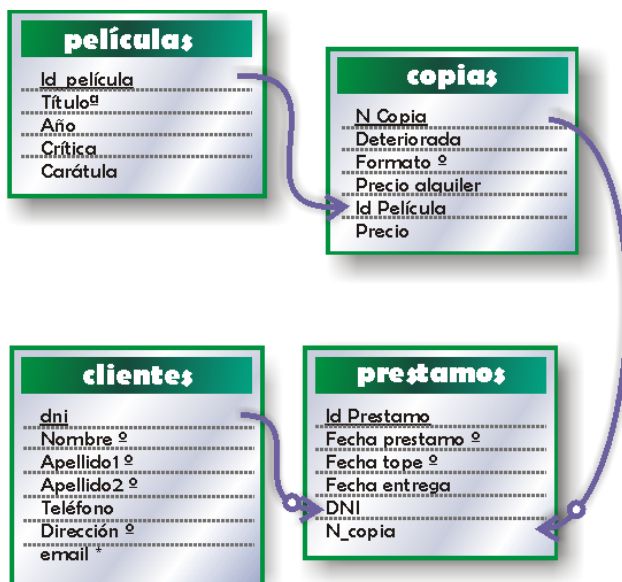
Ilustración 47, Esquema relacional completo de la base de datos de un Video Club
